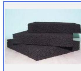
\*\*\* **ZM – PPI / CARB-20** // **Material soporte** : Sustrato de espuma tipo PUR de célula abierta PPI – 20 reticulado – Espesor Nominal 25 mm (+/- 10%) – Impregnada en carbón activado // Densidad aparente : 120 Kg. / m<sup>3</sup> // Volumen (DIN 53420) : 30 Kg. / m<sup>3</sup> // Tamaño del poro ( Z / cm ) : 4 – 6 // Contenido de aglutinante (Acetato de vinilo y etileno) : 10% Contenido de Carbón : 50 Kg / m<sup>3</sup>
